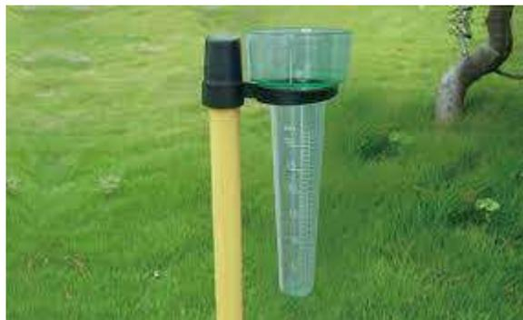
**Figura 2.4.** Modelo de pluviómetro.
