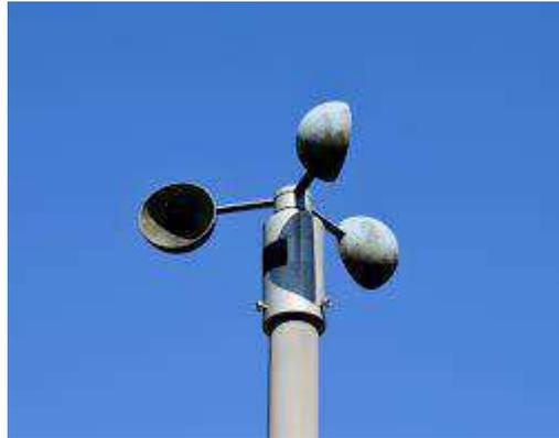
**Figura 2.6. Modelo de anemómetro**
